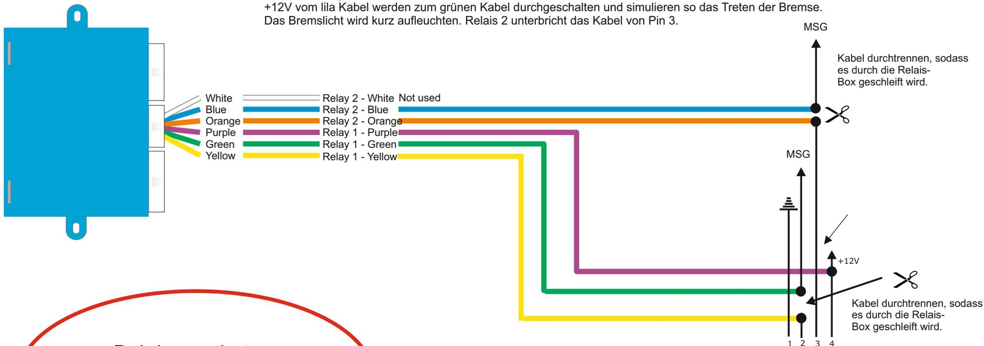
Bei demontiertem Bremspedalschalter nicht das Bremspedal treten!
