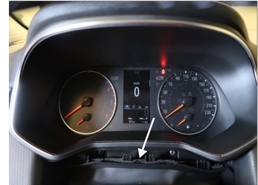
Kunststoffabdeckung entfernen und dahinter liegende Schrauben lösen.
