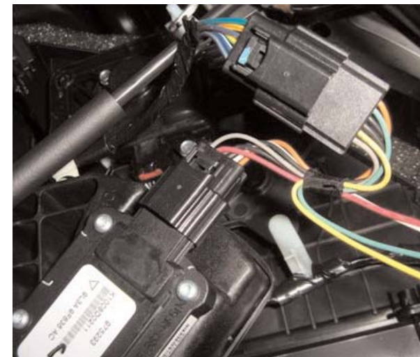
Grüner Stecker hinter der linken Seitenabdeckung des Armaturenbretts. CAN hi - Pin 9 (weiß/grau) CAN lo - Pin 1 (weiß/orange)
