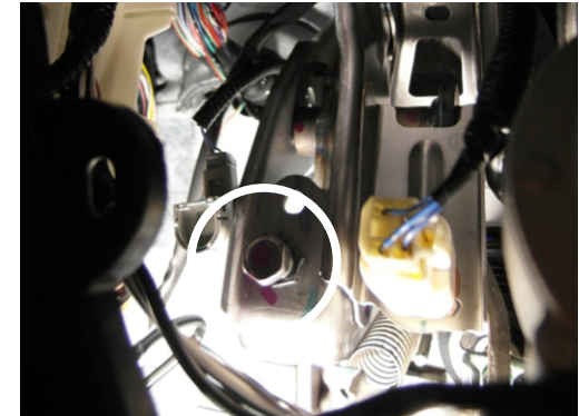
Den beigelegten Kupplungsschalter so justieren das der Pedal Stop analog der originalen Position des Anschlags ist
