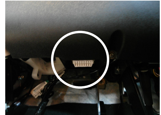
Original OBD Stecker vom Halter demontieren Y-Kabel dazwischen stecken OBD Stecker wieder in die Halterung montieren.
